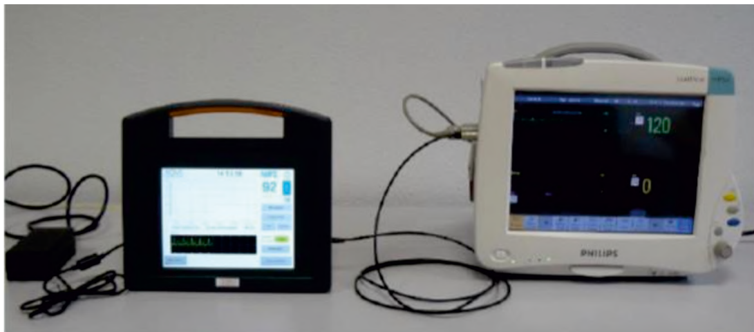
Figura 6.2. Conexión entre NIPE y el monitor multiparamétrico. Fuente: NIPE Monitor V1 User Manual.
