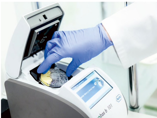
Figura 19. Ejemplo de dispositivo POCT (pruebas de laboratorio realizadas en el lugar de asistencia al paciente) para la medición de HbA1c, de Roche Diagnostics. Fuente: Sistema Cobas B 101. Roche Diagnostics. (n.d.).
