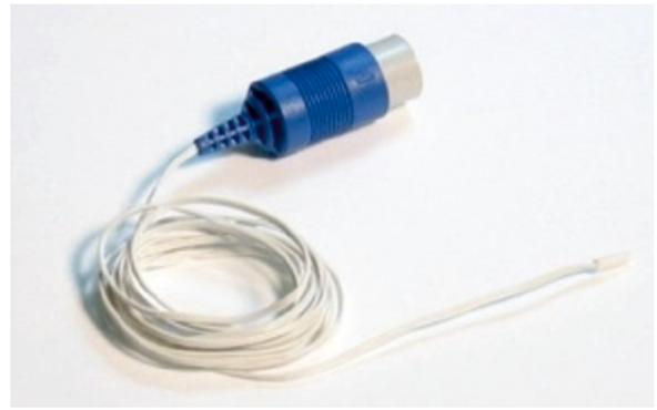
Figura 4. Sonda de temperatura neonatal.
